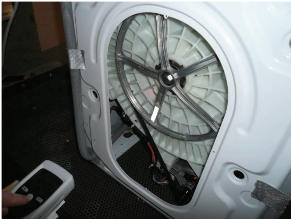
Figure 10 : Mesure de la vitesse de rotation du tambour par un tachymètre laser.
