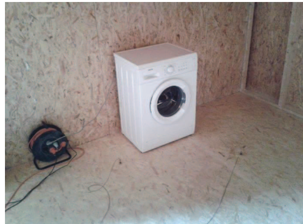
Figure 13 : Machine à laver installée sur le plancher bois (à gauche position centrale et à droite position au bord)
