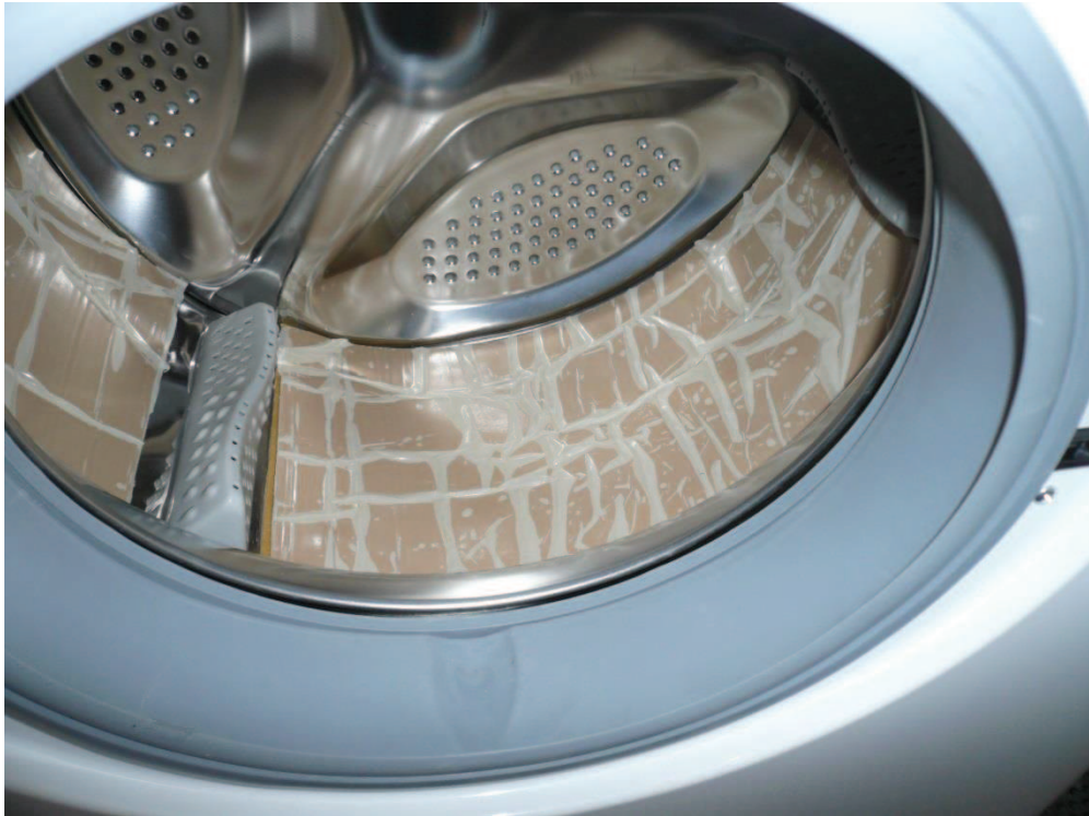
Figure 9 : Éléments de masse rajoutés dans le tambour de la machine à laver.
