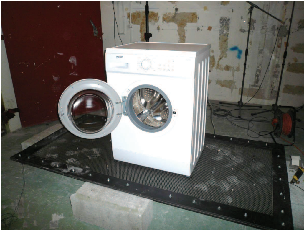
Figure 11 : Machine à laver installée sur la paroi réceptrice légère perforée
