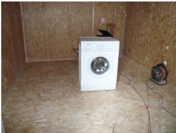
Figure 13 : Machine à laver installée sur le plancher bois (à gauche position centrale et à droite position au bord)
