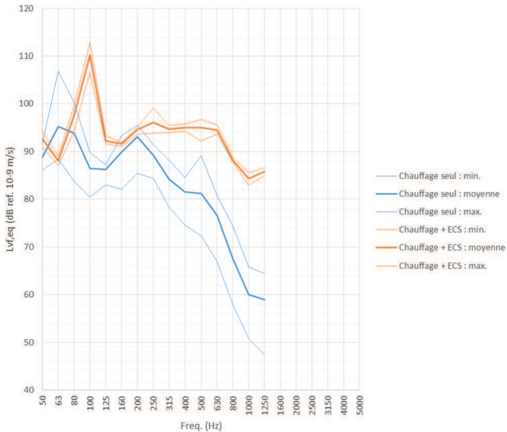
Figure 6 : Chaudière murale – Niveau de vitesse libre équivalente
