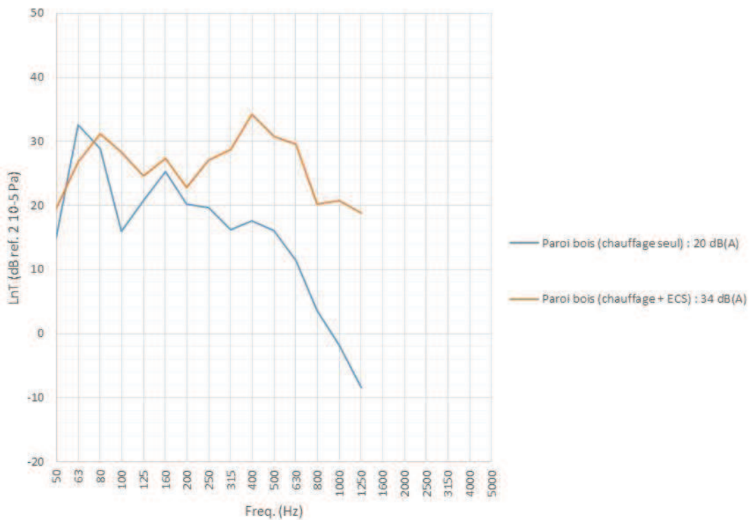
Figure 22 : Chaudière murale – Niveaux de pression acoustique estimés sur site (transmission filante latérale horizontale)
