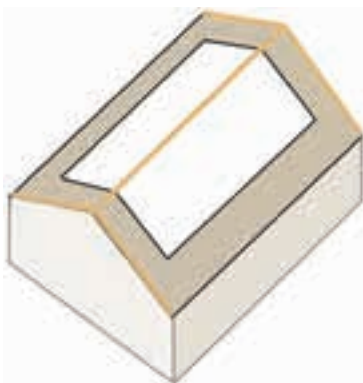
Figure 7.4. Poutres dans les plans de la toiture
