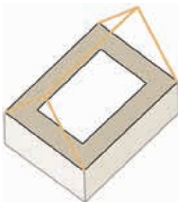
Figure 7.5. Poutres dans le plan des entrants
