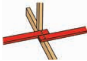
Figure 2.7. Fixation des barres filantes
