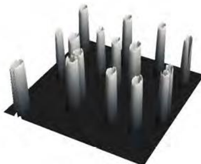
Figure 6 : Reconstitution des vaisseaux du bois de l'image grâce à la décomposition par ondelettes
