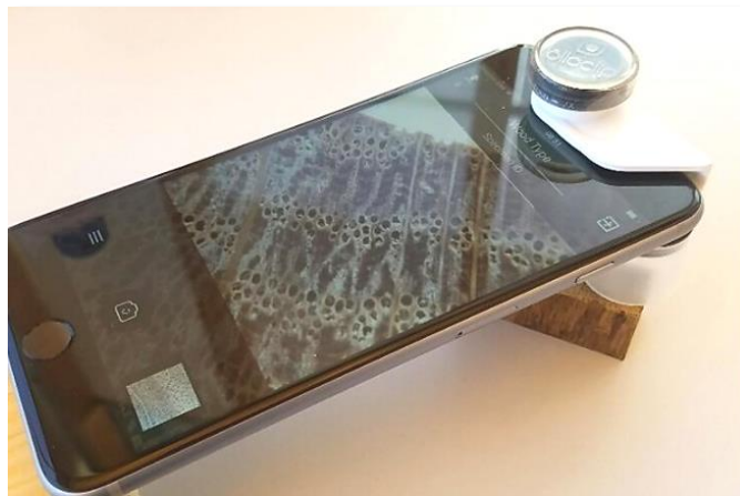
Figure 1 : Iphone 6S avec macrolens et application Xylorix
