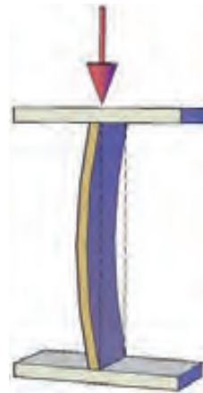
La compression axiale avec risque de flambement pour les pièces longues
