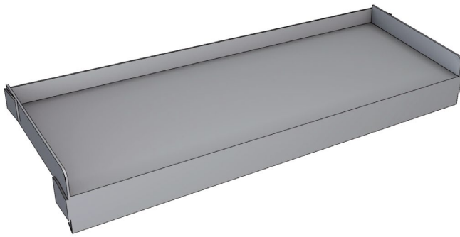
Figure 25 : Exemple de précadre étanche soudé
