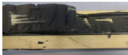
Photo 2 - Rupture cohésive avec délamination du support (arrachement de fibre de bois) Fab N°1 – M3 – pin brut + IF – après 7 jours d'immersion sans primaire
