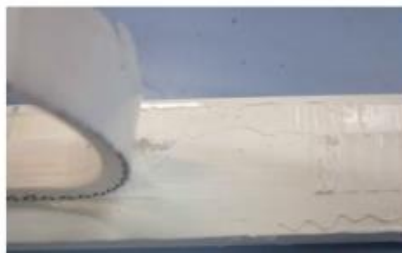
Photo 9 - Rupture avec perte de lasure Fab N°2 – M4 – pin peint. blanche – après 7 jours d’immersion sans primaire
