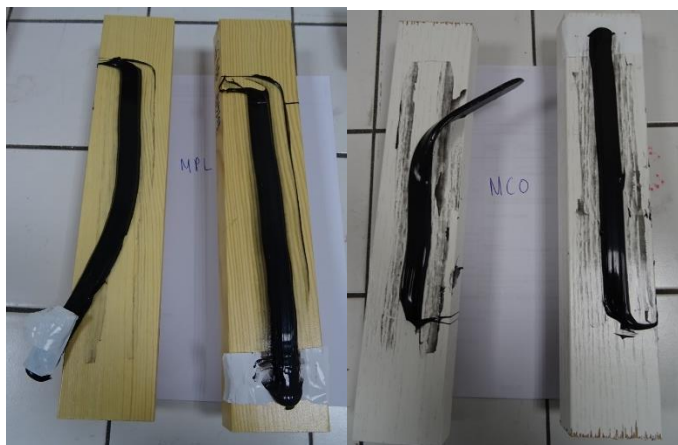
Photo 7 - Rupture 100% adhésive Fab N°2 – M2 – pin lasuré et chêne peint. blanche – à l'initial sans primaire
