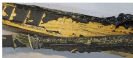
Photo 6 - Rupture avec perte de lasure Fab N°1 – M4 – chêne lasuré – après 7 jours d’immersion sans primaire
