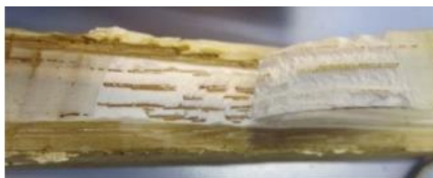
Photo 10 - Rupture cohésive avec délamination du support Fab N°1 – M5 – chêne brut après 7 jours d’immersion sans primaire
