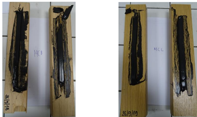
Photo 11 - Rupture 100% cohésive Fab N°4 – M2 – chêne brut et lasuré – à l'initial sans primaire
