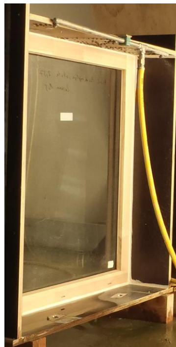
Photo 3 : Essai radiant sur fenêtre VEC
