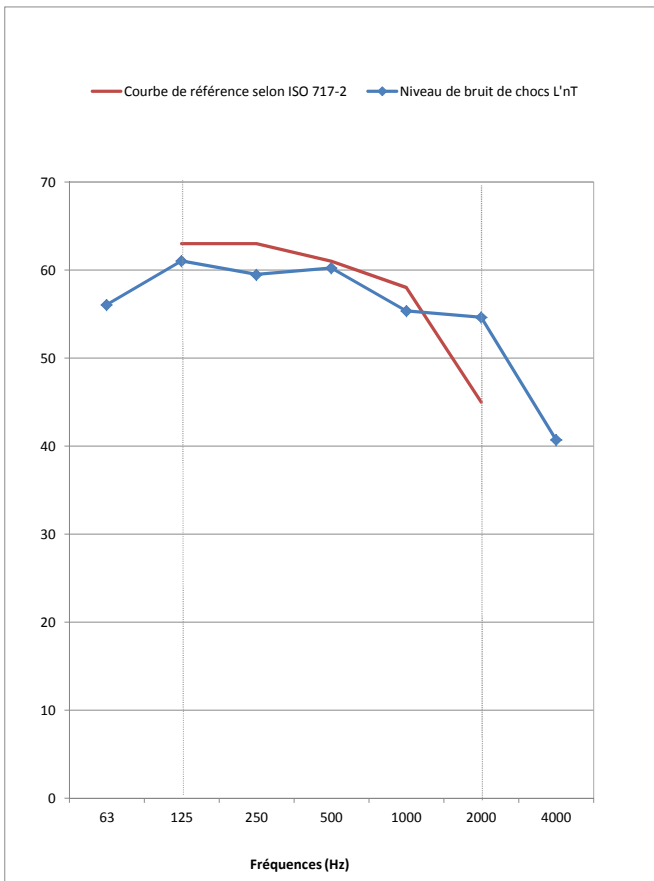
Courbe de niveau de bruit de chocs L'nT (dB) par bande d'octave
