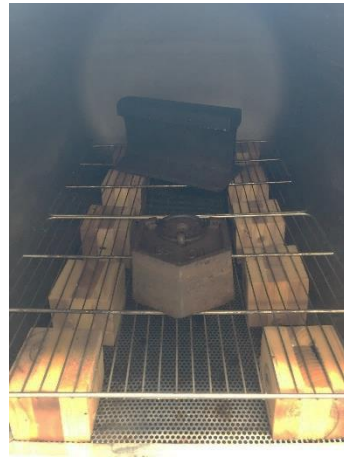
Photo 4 : Mise en place de poids pour lester les épreuves
