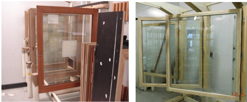
Photo n°3 : essai stabilité diagonale
