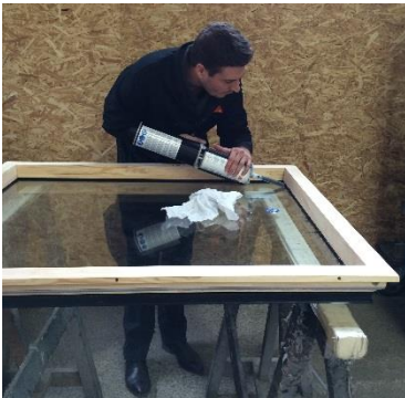
Photo n°2 : Extrusion du mastic SIKASIL WT480
