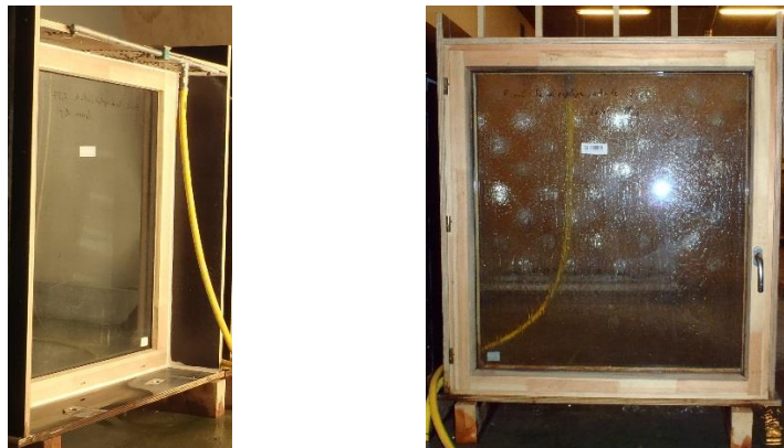
Photo n°7 : essai radiant phase de chauffe et de refroidissement concept n°2
