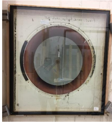
Photo n°4 : essai fixation vitrage sur concept N°2
