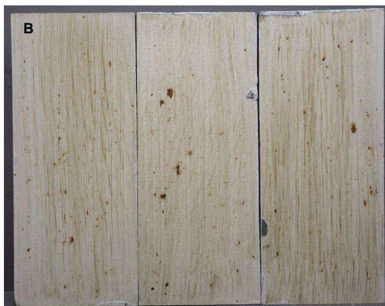
Figure 38 : Aspect des échantillons de chêne revêtus avec le bloqueur B, après l'exposition climatique cyclique
