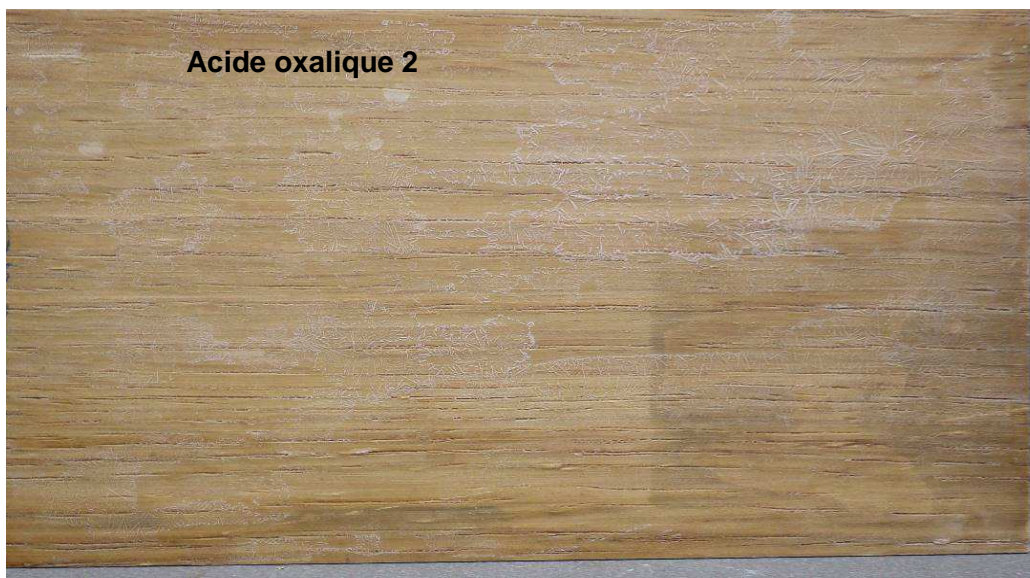
Figure 66 : Epreuves de chêne revêtues par le bloqueur transparent E après test de condensation et nettoyées à l'aide de différentes solutions
