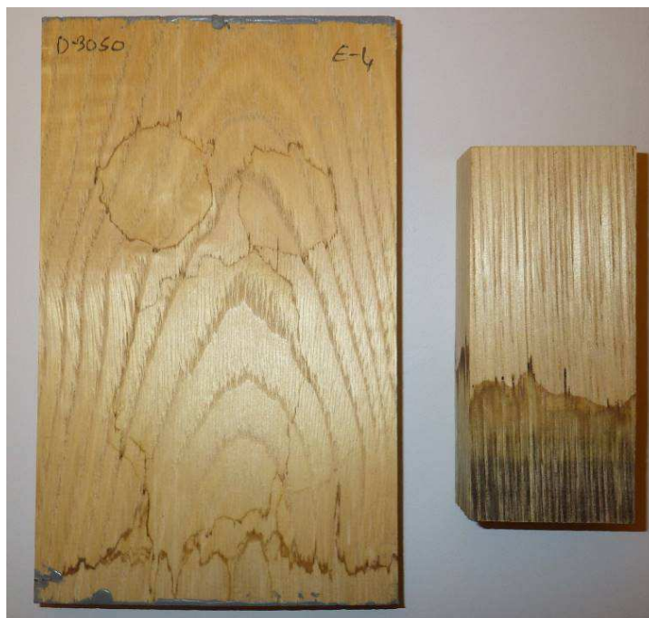
Figure 15 : Epreuves de chênes tachées par dépôt de goutte d'eau en surface (à gauche) et par immersion partielle dans de la soude (à droite)
