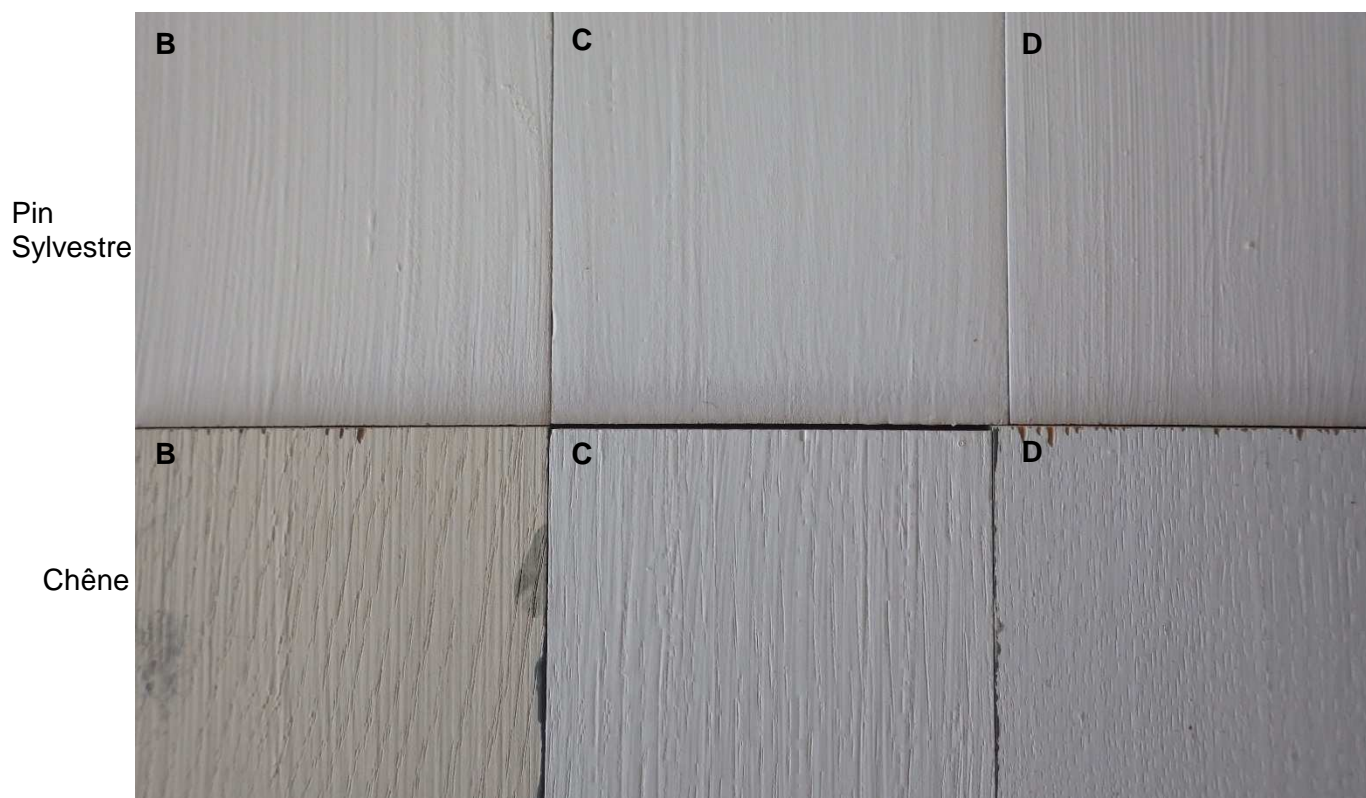
Figure 30 : Bloqueurs B, C et D appliqués sur pin sylvestre (en haut) et chêne (en bas)
