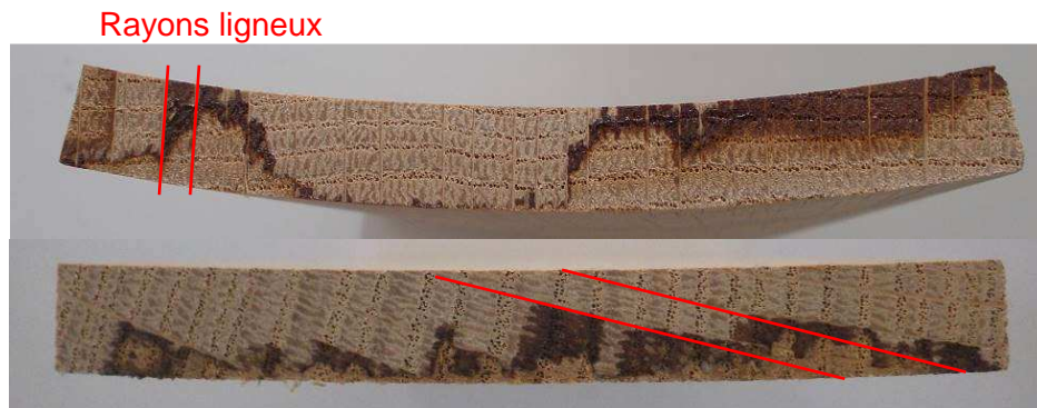
Figure 12 : Migration des tannins au niveau des bois de bout après passage à la blister box sur chêne découpé sur dosse (en haut) et sur faux quartier (en bas)
