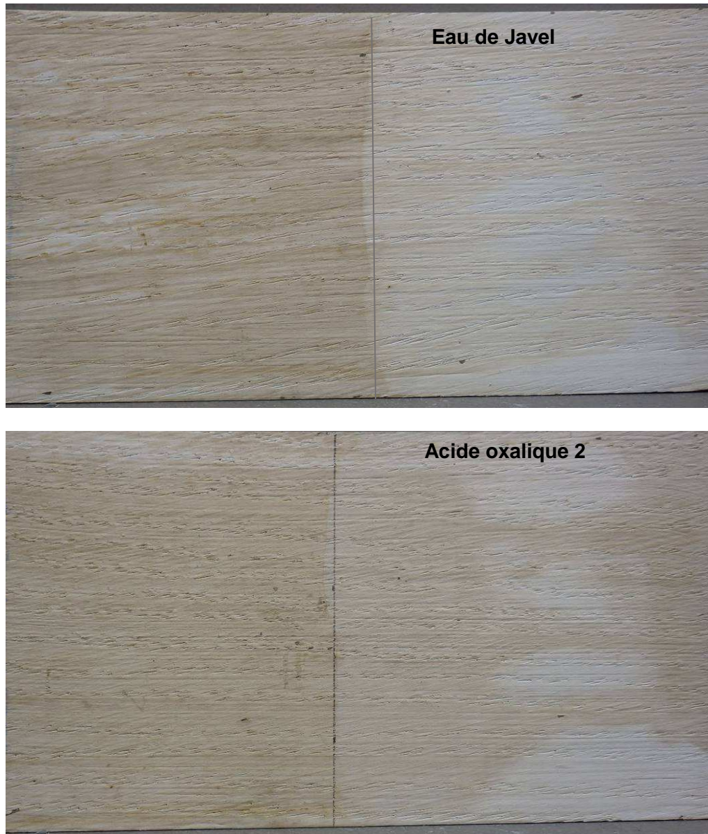
Figure 65 : Eprouvettes de chêne revêtues par le bloqueur blanc B après test de condensation et nettoyées (côté droit de l'éprouvette) à l'aide de différentes solutions
