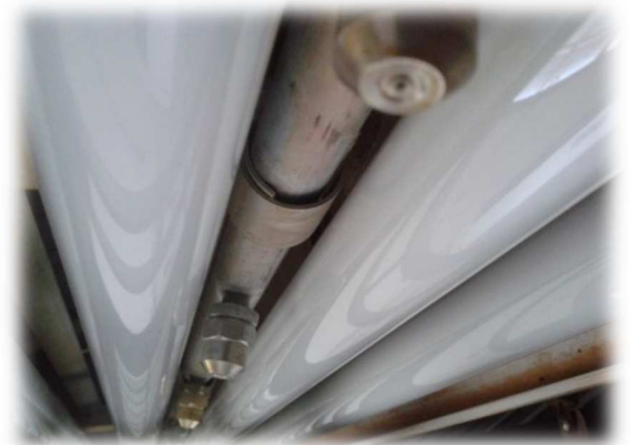
Figure 9 : Buses de pulvérisation du QUV
