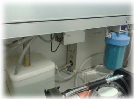
Figure 4 : Circuit de purification de l'eau du QUV
