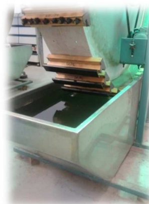
Figure 18 : Passage dans l'eau osmosée
