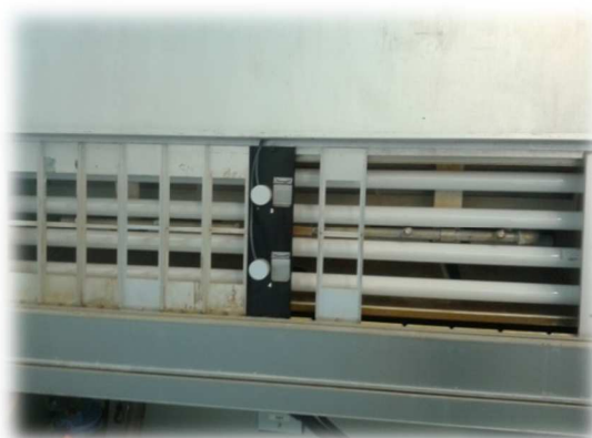
Figure 2 : Enceinte QUV ouverte
