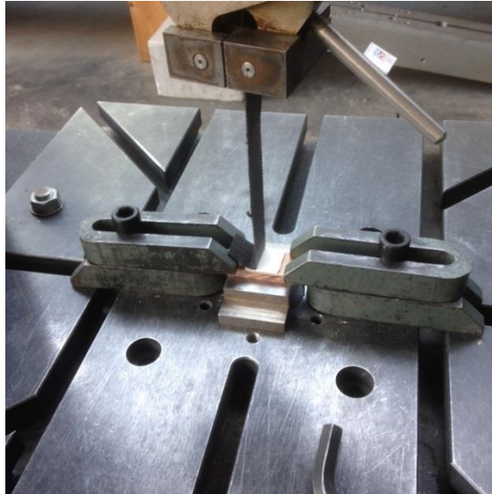
Photo 3 : montage pour essais selon la norme NF ISO 813 :2016
