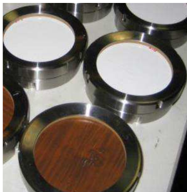
Figure 3 : Eprouvettes de bois revêtues de finition dans les coupelles de test
