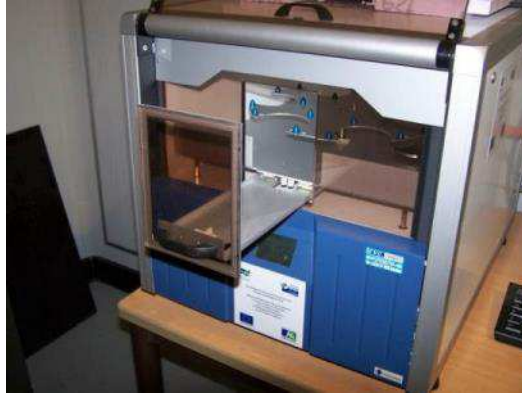
Figure 5: Appareil de mesure de la perméabilité à la vapeur d'eau (GraviTest, Seitter GmbH)
