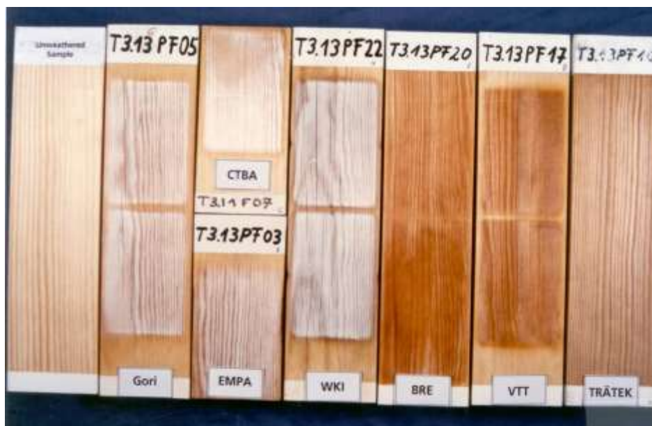
Figure 2: Réponse des 7 cycles sur le bois nu - pin sylvestre- (témoin non vieilli à gauche)
