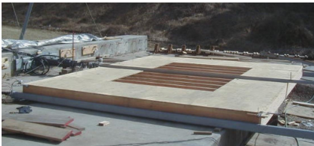
Figure 4-7 : Plancher de 5 x 6 m avec ouverture centrale
