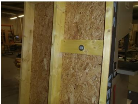
Figure 6 : Maquette n°4 – ½ maquette / Traversée de paroi (tuyau PVC Ø 125 mm)
