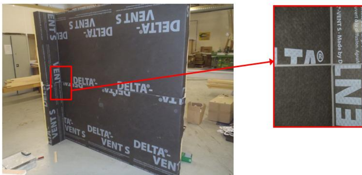
Photo 9 : Montage de la maquette n°3 / Mise en œuvre du pare-pluie et des MIP
