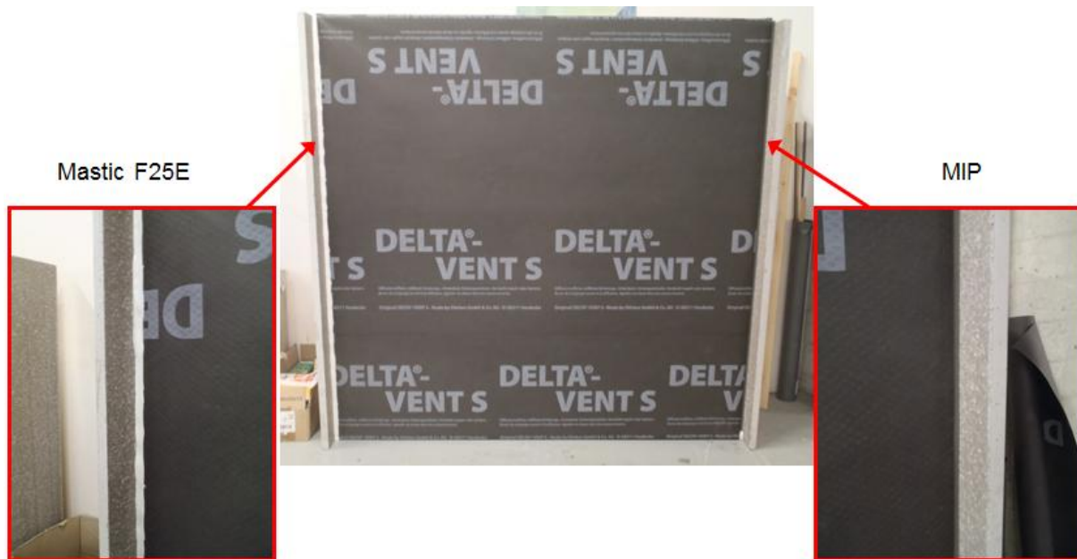
Photo 16 : Montage de la maquette n°5 / Mise en œuvre du pare-pluie et des calfeutrements mastic ou MIP
