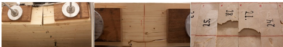
Tablier lamellé-collé pré-contraint (dispositif d'essai et modes de rupture)
