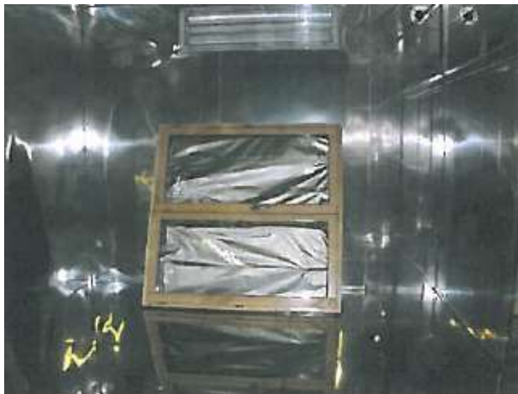
Figure 18 : Exemple de fenêtre colmatée avec du film aluminium (12/1125R/17-1)
