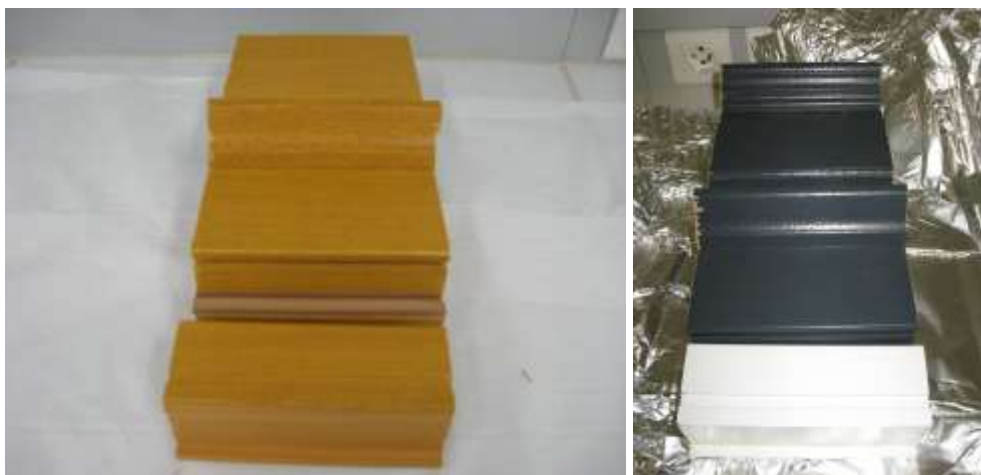
Figure 16 : Echantillons 12/1125R/12 et 12/1125R/13 (épreuve de vantail + linéaire d'hubriserie)
