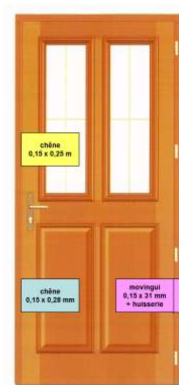
Figure 20 : Découpe de l'éprouvette d'essai dans les portes menuisées
