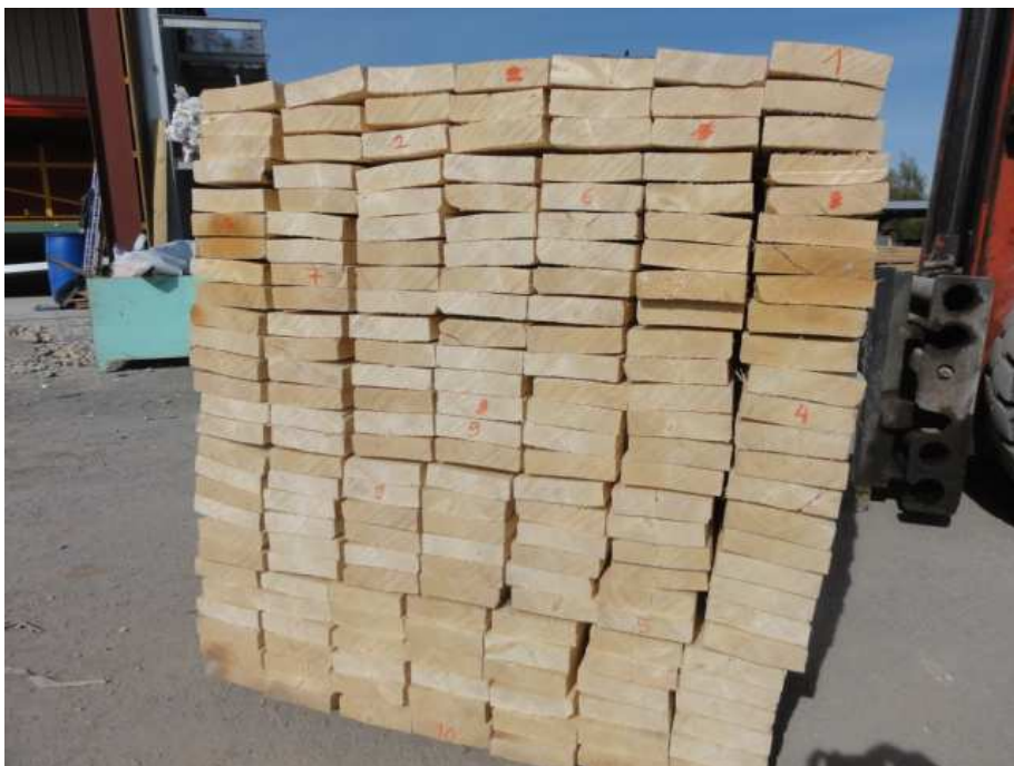
Photo 2 : Pas de lattage, bois sur bois, société A.
