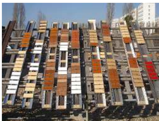
Figure 3: Site de vieillissement naturel de FCBA Bordeaux
