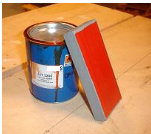
Photo 1 : Seule la surface d'essai est recouverte de la finition à tester. Toutes les autres faces sont soigneusement scellées avec un produit contrôlé (ici en gris)
