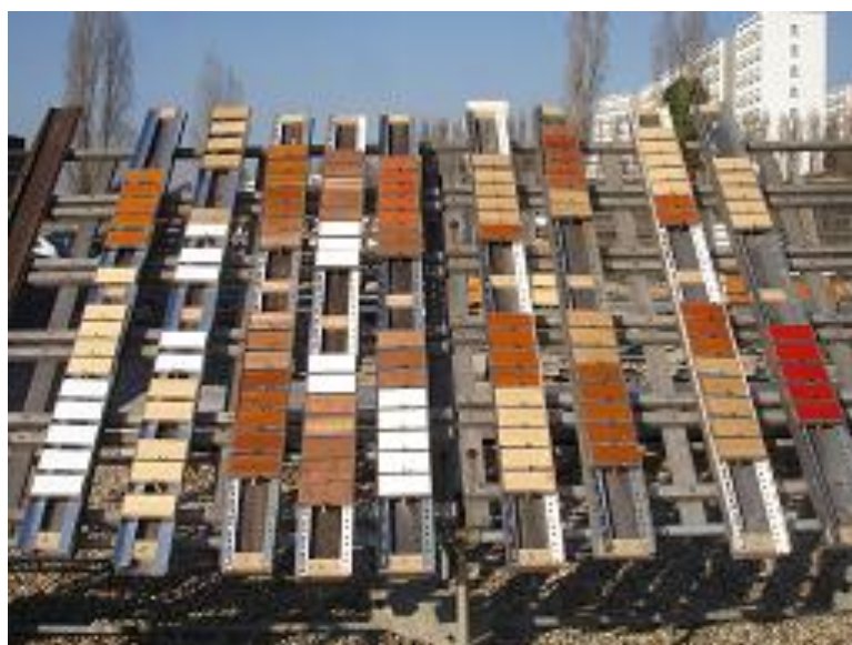
Photo 2 : Les éprouvettes ont été exposées 1 an à Bordeaux
