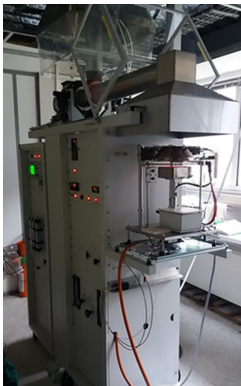
Figure 1. : banc d'essai cône calorimètre selon ISO 5660-1
