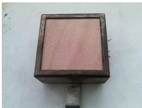
Figure 2 : photo échantillon de bois dans le porte éprouvette métallique
