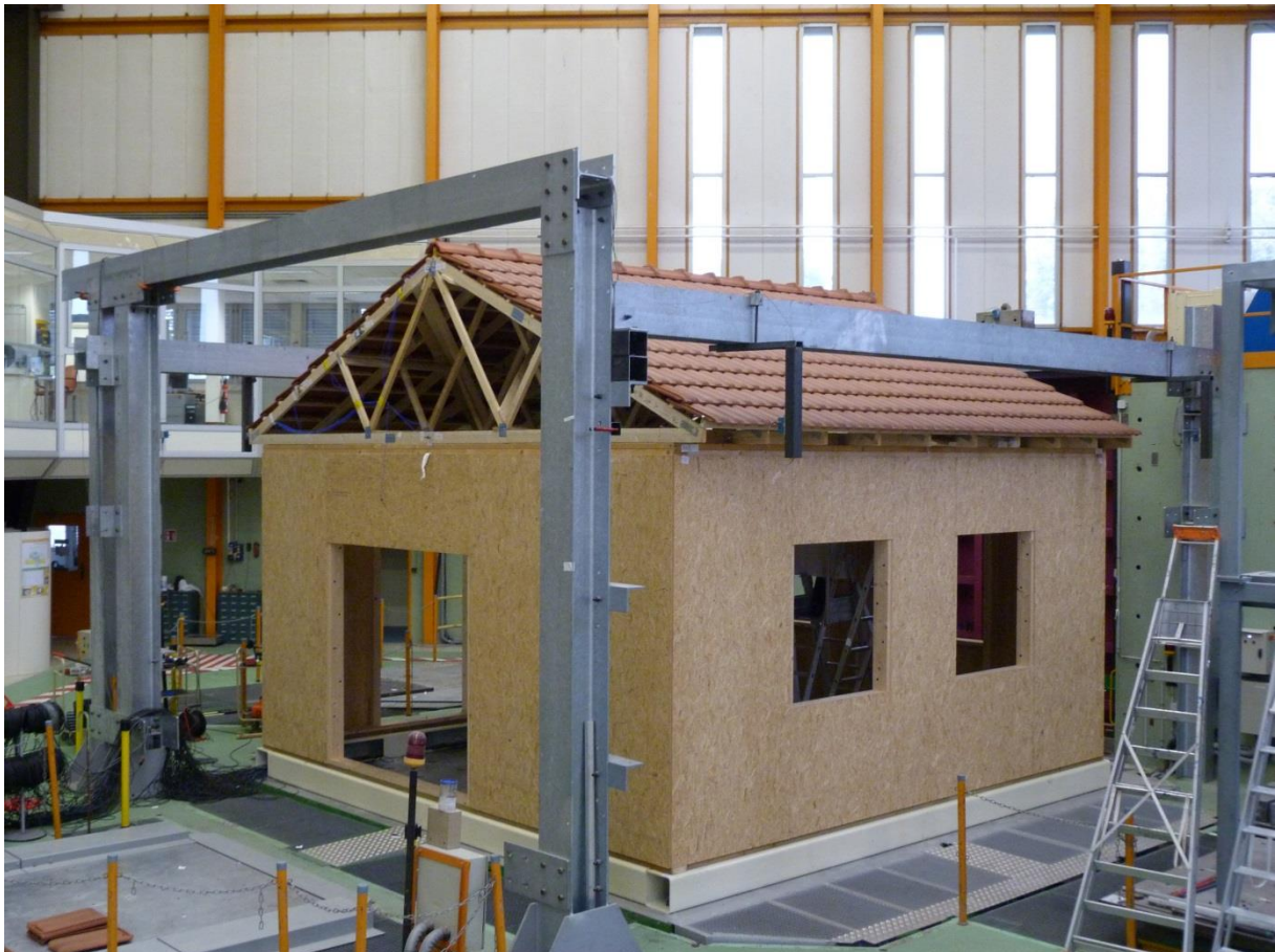
Figure 5-6 : Essai sismique au CEA avec murs à ossature bois (projet SISBAT)
