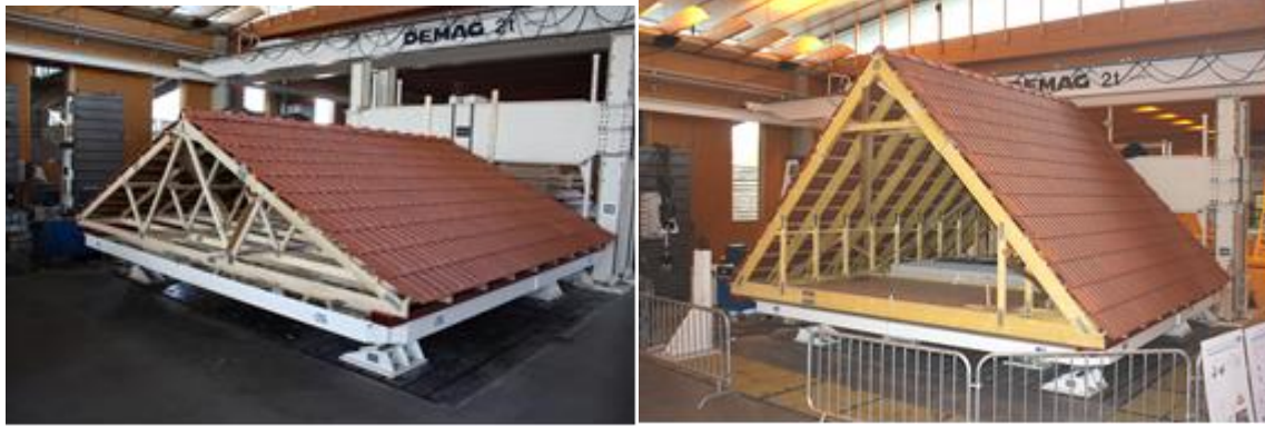
Figure 5-2 : Essais sur charpentes - Sens Y
