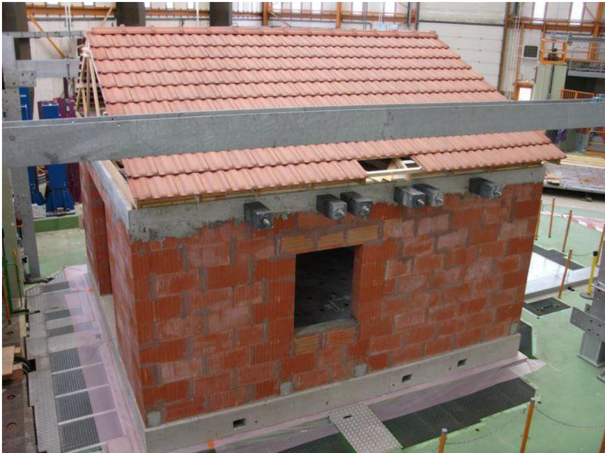
Figure 5-7 : Essai sismique au CEA avec murs maçonnés (projet SISBAT)
