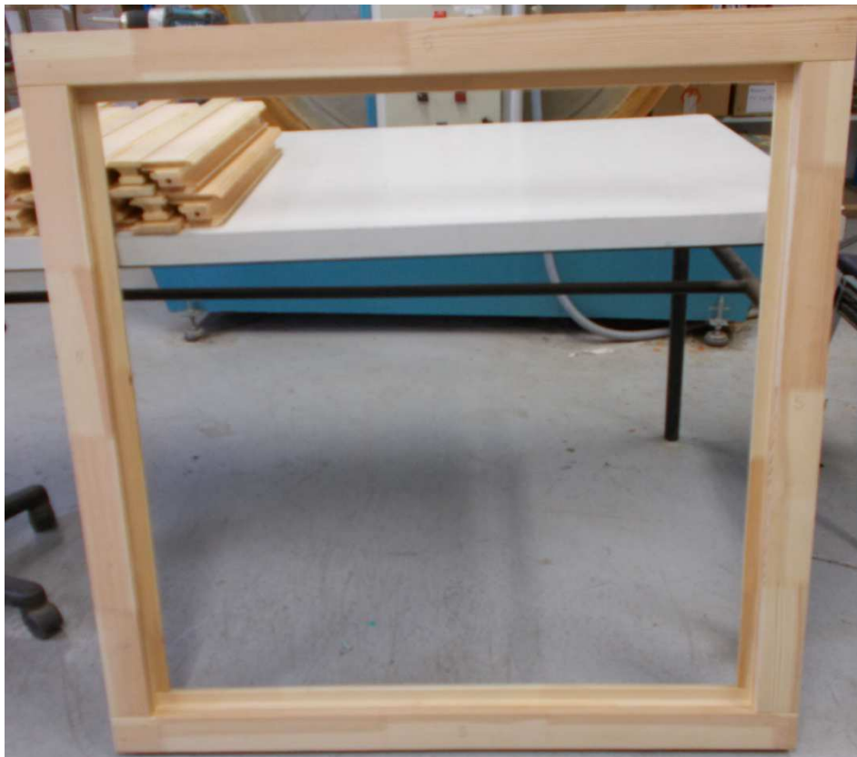
Figure 2 : cadres réalisés avant application des finitions puis découpe des éprouvettes
